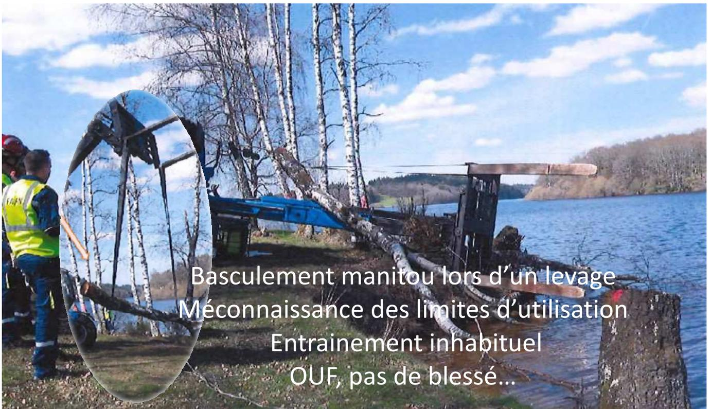
Basculement manitou lors d'un levage
