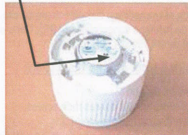
au dos, le marquage de la source radioactive
