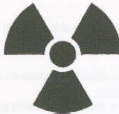
Marquage des détecteurs contenant des sources (norme NFM 60-101)
